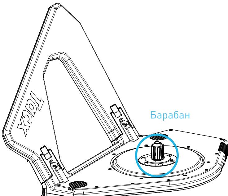
3. Определите, нужно ли использовать проставочное кольцо под ваш тип кассеты. Установите кассету на барабан.
