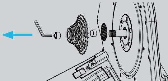
2. Установите 2 проставки из комплекта (T2805.11 и T2805.12) на заднюю часть оси.
