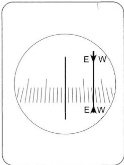
**Регулирование оптической системы:** в моделях КН-14/D, КВ-14/opti и в новой КВ-20 оптическую систему пеленгаторного компаса можно юстировать, поворачивая пальцами оптическую трубку способом. Регулируйте оптическую трубку так, чтобы сетка отсчетов осталась в вертикальном положении.
