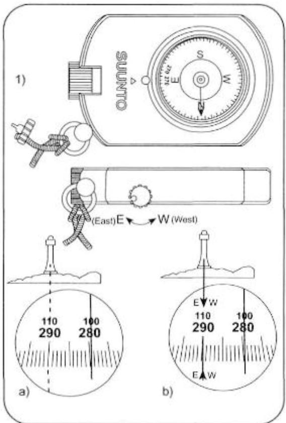
Магнитное склонение: магнитное склонение есть разность между магнитным севером и севером на карте. Величина местного магнитного склонения обозначена на краю карты либо как восточное склонение плюс (E), либо как западное склонение минус (W). Для считывания на карте направления, полученного с помощью компаса, следует прибавить плюсовоое или минусово склонение к направлению по компасу. Когда отсчет берется по карте, и соответствующий отсчет хотят по компасу, действуют наоборот.
